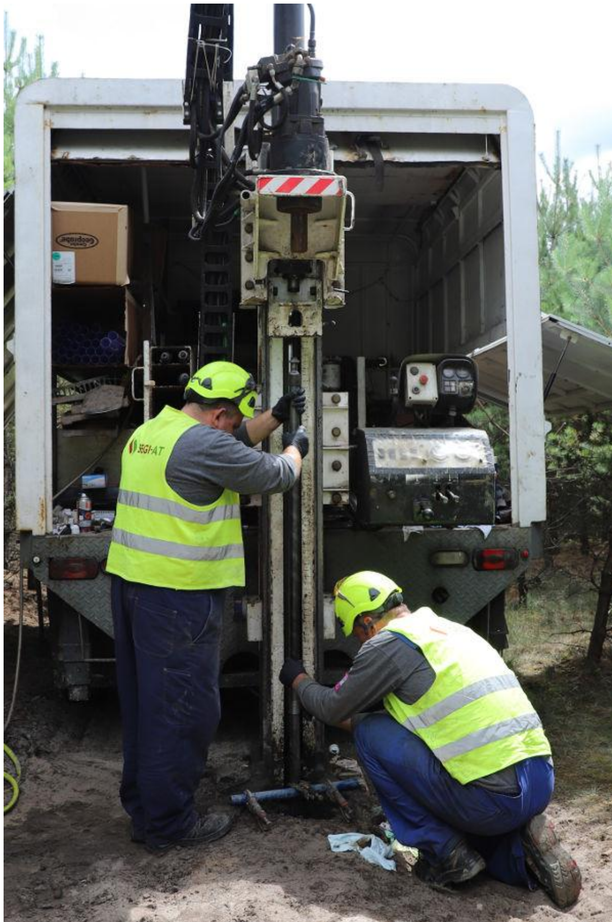
Fot. 1. Odwiercanie otworu do poboru prób gleby i ziemi
